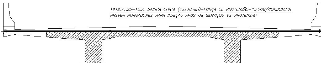
Figura 5 – Armadura transversal de protensão para o alargamento e reforço da laje.
